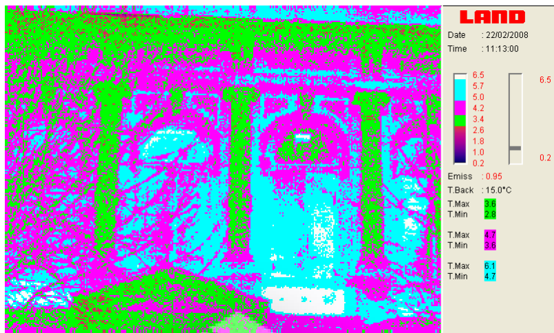
Мал 1.3. Зеленим, бордовим та голубими кольорами позначені зони с заданими межами температур (межі температур показані справа від термичного зображення).
